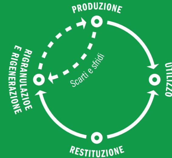
**Tutti gli impianti di Soffiaggio sono dotati di macchine di macinazione e di rigranulazione delle materozze e degli scarti per il recupero immediato di questi nella produzione da cui sono generati. Tre impianti di macinazione e rigenerazione consentono il recupero degli sfridi e degli scarti della Divisione Film e della Divisione Contenitori.**
