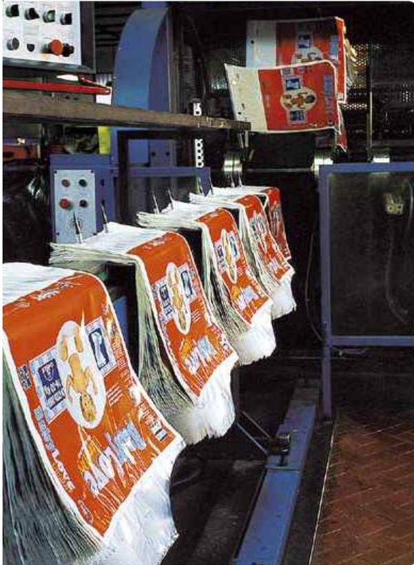
È una busta caratterizzata dalla presenza di un "cavaliere" applicato che forma la maniglia per il trasporto (tipo "compact"); per il tipo non compresso la maniglia è ottenuta tramite fustellatura direttamente sulla busta. Le buste per pannolini possono essere stampate fino a otto colori per lato e con eventuali quadricromie. Il materiale per la fabbricazione di queste buste è un coestruso a tre strati.
