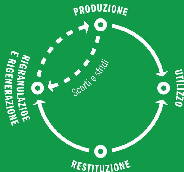
**Tutti gli impianti di Soffiaggio sono dotati di macchine di macinazione e di rigranulazione delle materozze e degli scarti per il recupero immediato di questi nella produzione da cui sono generati. Tre impianti di macinazione e rigenerazione consentono il recupero degli sfridi e degli scarti della Divisione Film e della Divisione Flaconi.**
