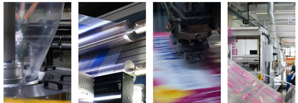
**Grazie alla totale integrazione verticale dei suoi processi produttivi basata sul Ciclo Continuo Integrato (7gg/7 - H24), dall'estrusione del film, la stampa, la saldatura e taglio tutto è eseguito internamente presso lo stabilimento di Prato; la gestione degli ordinativi è ottimizzata per garantire il rispetto dei tempi di consegna anche a fronte di richieste urgenti e/o particolari.**
